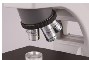
半導体素子観察も可能な、大型ステージを標準装備。移動距離150 × 100mm で大きな試料も観察可能です。
