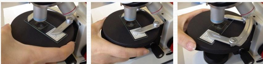
■ 丸型のステージは、横・縦・回転・斜め方向へ自在に動かすことができます。プレパラートを動かして見たい対象を探すより簡単に対象を探すことができ、観察しやすくなっています。
