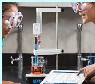
中和点付近で、中和熱により溶液の温度が最大になり、また溶液中のイオンが最低になることが分かります。
