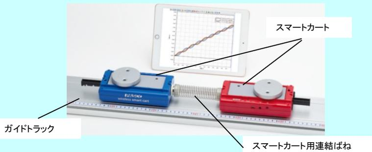
2台のスマートカートのカセンサにスマートカート用連結ばねを取り付け、スマートカートの一方に初速をあたえて2台の carts の動きと重心の動きをソフトウェア上で観測します。重心の運動は等速直線運動で2つの carts の速度は入れ替わることが確認できます。
