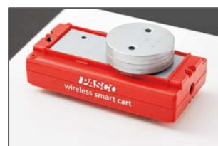
ME-1240MS/1241MSは、本体におもり取り付け板と加重おもり(250g 2個)がセットになっています。
