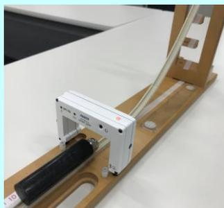
移動距離は衝突実験器のスケールの目盛を読み、手入力します。ワイヤレススマートゲートで速度を測定し、ソフトウェアで計算式を設定して速度の2乗を求めます。
