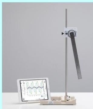
ワイヤレス回転運動センサの三段プーリーを外して軸と固定ネジの間に30cm定規を挟み、定規の下端に丸磁石2個をつけて剛体振り子をつくります。下図は角度・角速度・角加速度の時間的変化を示しています。
