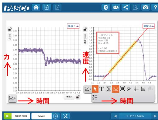
グラフの実験結果は、スマートカート(質量0.25kg)をおもり40gで滑車を通して牽引した場合の結果です。
