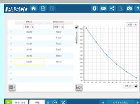
SPARKvueで左側を手動入力表、右側をグラフに設定します。左側の表に予め数値(mL)を入力し、その数値に合わせてシリンダを押し引きし、測定します。
