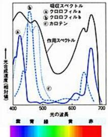
測定例：シソの葉から抽出した溶液の吸収スペクトル
