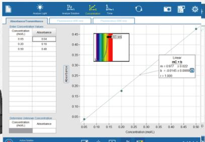
測定例：593nmにおけるCuSO<sub>4</sub>溶液の濃度と吸光度の関係
