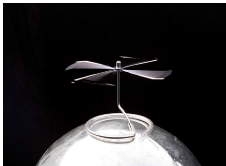
ハミルトン電気回転車を頭部にのせると、電気風の反作用で回転します。
