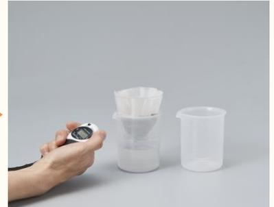
水がろ紙から落ちてくる時間を測ります。3種類の砂で同様に実験し、時間を違いを確認します。
