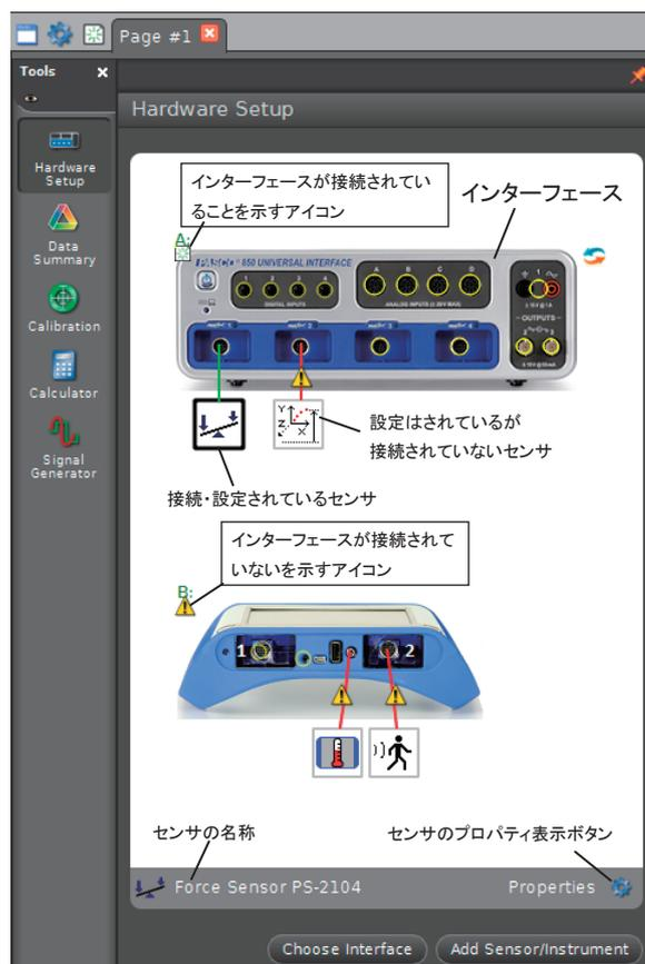
図 9 Hardware Setup パネル
