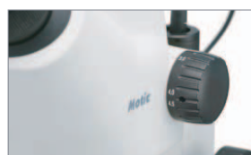
「ズーム対物レンズ」ズーム比率がワンタッチで調整可能。(STZ-161/171シリーズ共通)
