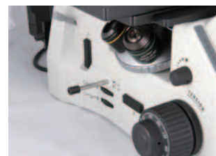
明視野 Bright Field (BF)・暗視野Dark Field (DF)がワンタッチで切り替え可能
