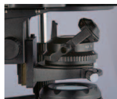
はねのけコンデンサを使用する事により低倍率での観察が最適に行えます。
