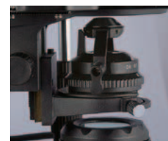
はねのけコンデンサを使用する事により低倍率での観察が最適に行えます。
