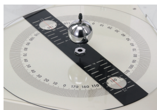
振動面の方向と振幅が読み取りやすい角度板
