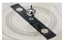
振動面の方向と振幅が読み取りやすい角度板
